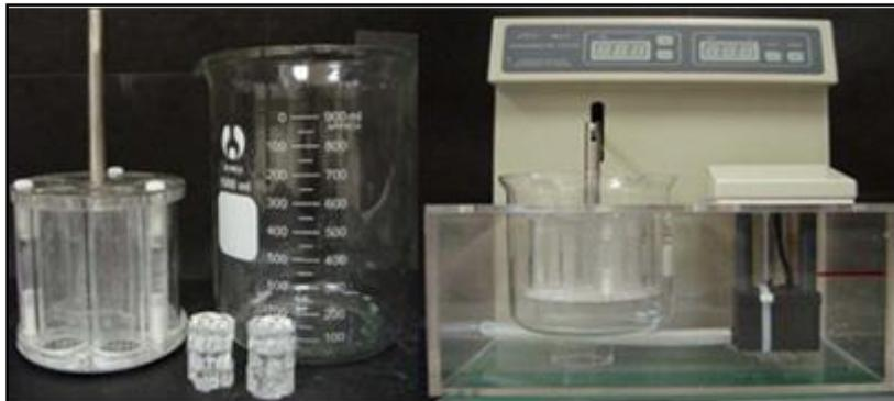
**Figure 26: Photographie de l'appareil de test désagrégation**
