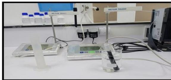
**Figure 23 : Conductimètre.**
